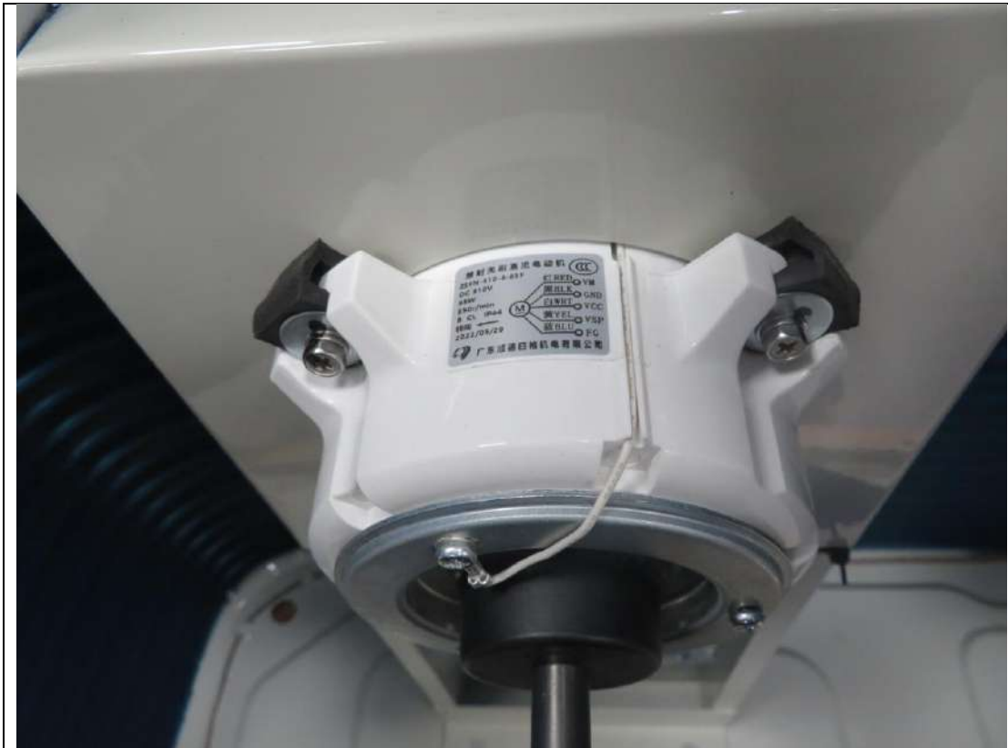
Picture 3 fan motor
